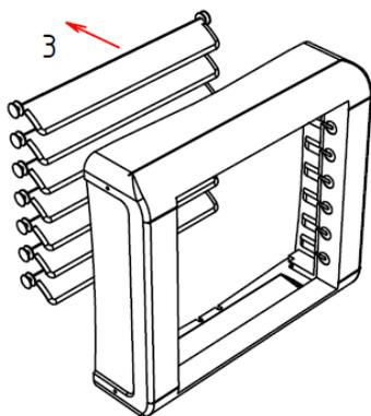
4 Установка конфузора в корпус тепловентилятора
