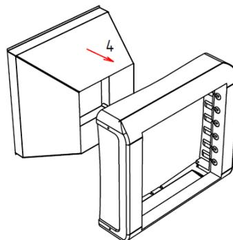
5 Монтаж корпуса с конфузором на теплообменник
