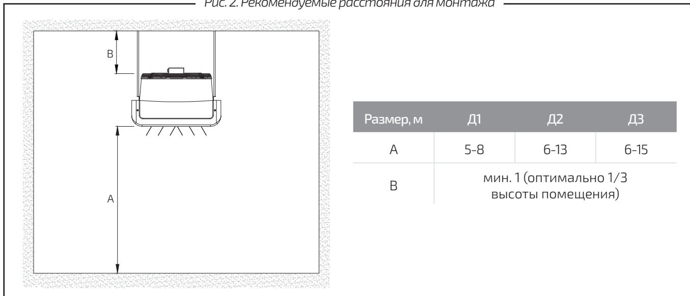
Рис. 2. Рекомендуемые расстояния для монтажа
